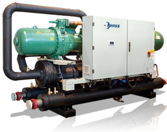
**Enfriadoras de agua con condensación por agua. Serie con compresores semiherméticos de tornillo stepless y gas refrigerante ecológico R513A.**
